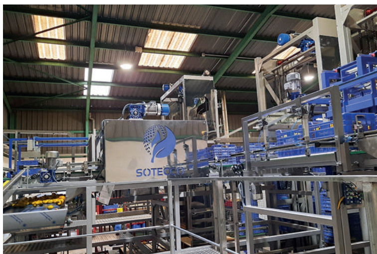
Conjunto de despaletizadores, volcador y enfardadora automática. / SOTECO
