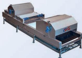
Gran cepillón de lavado, secado por turbinas, aire caliente con regulación de temperatura.
