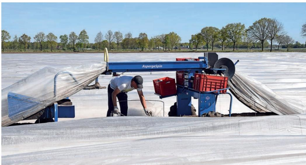
Algo único de la máquina AspergeSpin —patentado por Engels Machines— es la posibilidad de levantar dos plásticos a la vez. / EM
