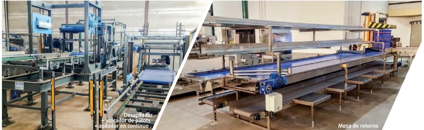
Desapilador + volador de palots + apilador en continuo
