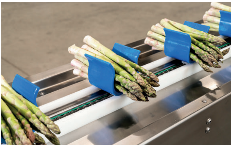
Para los espárragos verdes la preferencia es combinar la máquina clasificadora con la GUB Buncher, que agrupa los manojos automáticamente con dos bandas de goma o una banda de goma y una ElastiTag®. / STRAUSS
