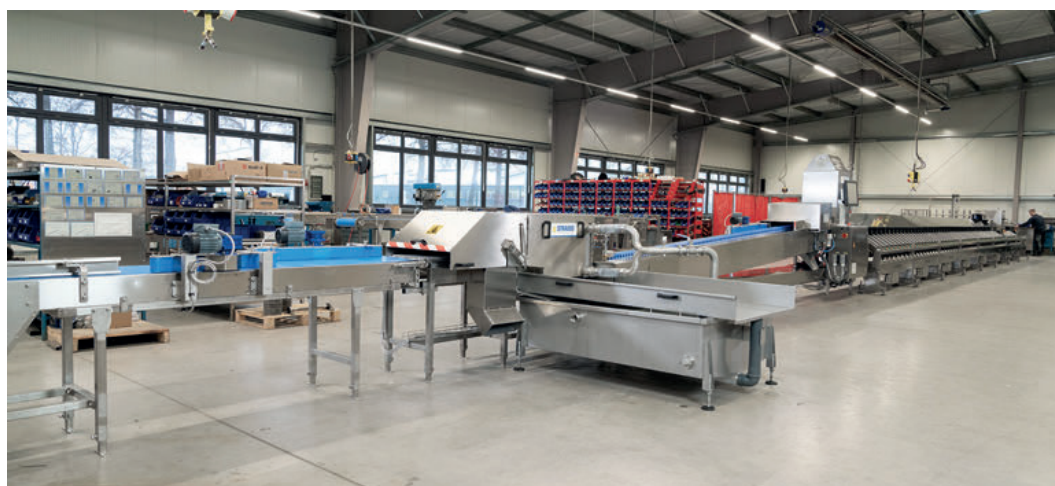
Las máquinas de clasificación de Strauss se construyen de forma modular lo que permite adaptar la máquina a las necesidades del cliente y al tamaño de la empresa. / STRAUSS
