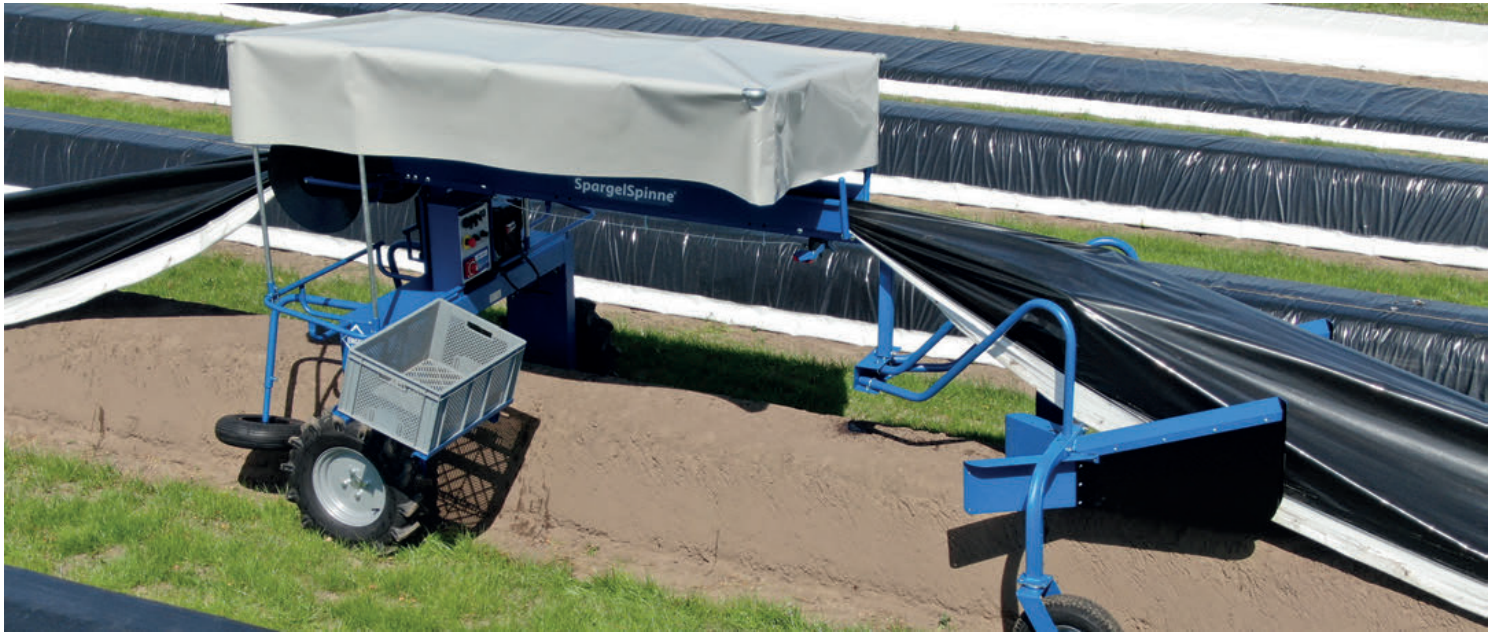
Con las cosechadoras AspergeSpin, el pesado trabajo de manipulación de los plásticos sobre el lecho de espárragos es asumido por la máquina. / ENGELS MACHINES.
