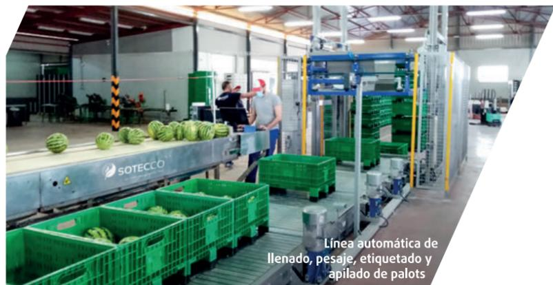
Línea automática de llenado, pesaje, etiquetado y apilado de palots
