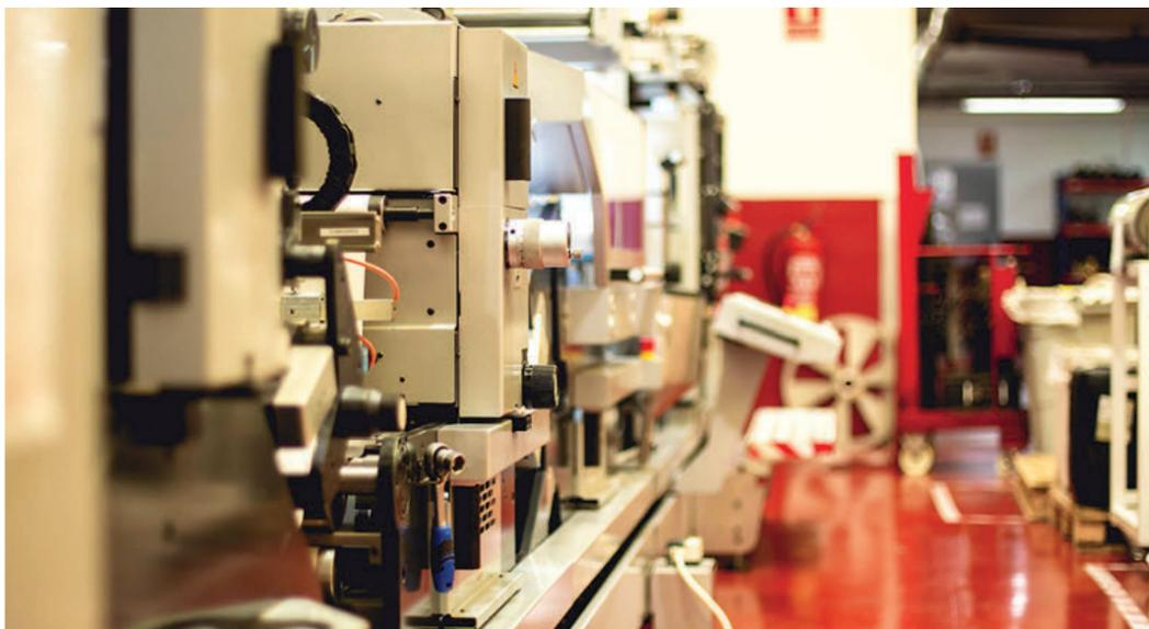
La nueva máquina flexográfica MPS EFS dispone de ocho colores, multilaminador y dos estaciones de troquelado. / ETYGRAF
