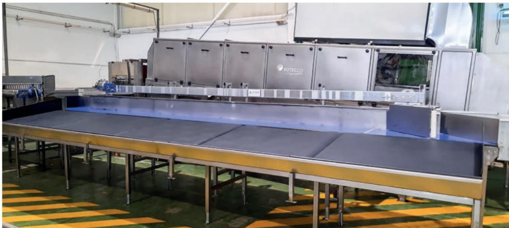
En la imagen túnel de secado de melón y sandía con mesa de confección. / SOTECO
