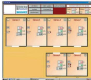
La visualización del estado actual de las cámaras se hace sobre un dibujo esquemático de las mismas, ofreciendo en una única pantalla toda la información relevante (temperatura, humedad, CO<sub>2</sub>, etileno, etc.), de forma clara e intuitiva.
