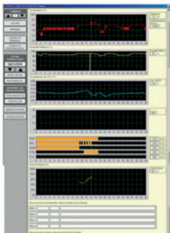
sualización y registro de las variables que intervienen en la desverdización: temperatura, humedad relativa, CO<sub>2</sub>, etileno, funcionamiento general del equipo, así como para la programación y ajuste de los niveles deseados de cada una de estas variables.
