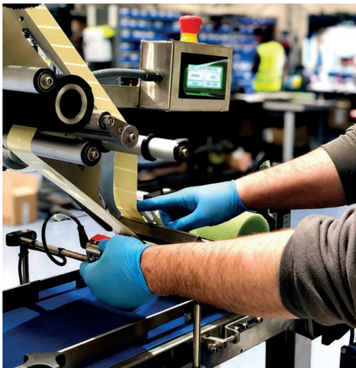
Los técnicos de Pampols se encargan de montar, instalar y reparar equipos y maquinaria de final de línea. / PAMPOLS PACKAGING
