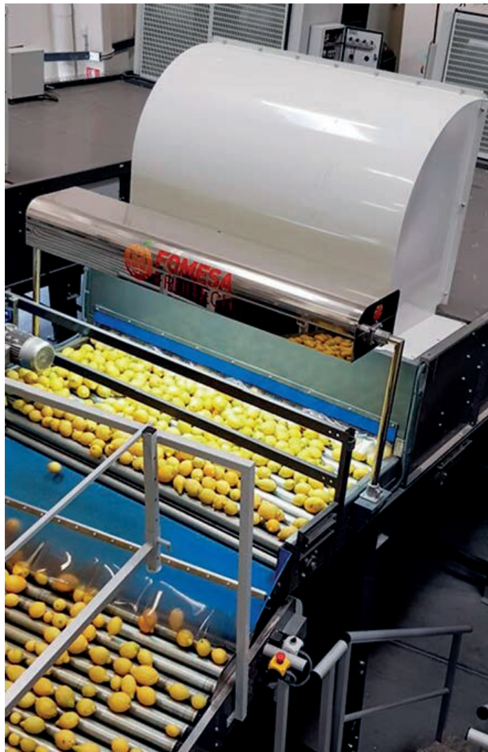
El Optical Control es un sistema de dosificación de fungicidas. / FOMESA FRUITECH
