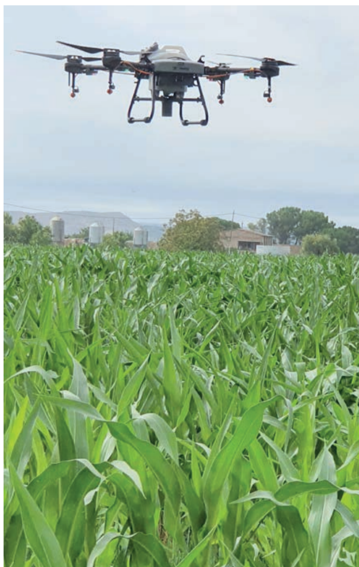
Dron DJI Agras T10 en aplicación sobre maíz. / PIRINEOS DRONEAVIATION
