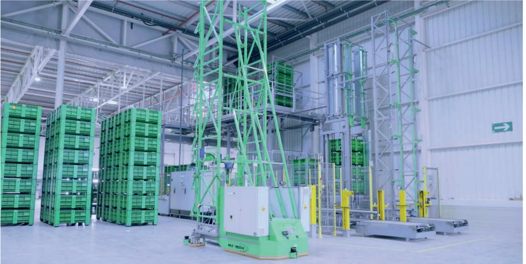
Los AGVs son vehículos de guiado automático que sustituyen a las tradicionales carretillas y permiten gestionar el trasiego de cajas o bins por el almacén de forma totalmente segura y eficiente. / MAF RODA
