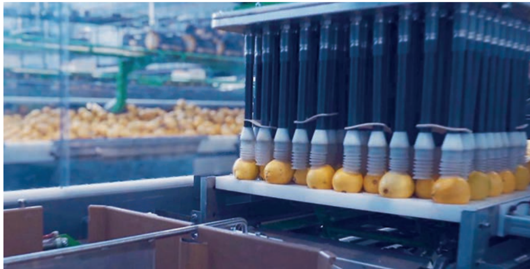
MGL es un sistema de confección a granel por peso que realiza un llenado y pesado directo al interior de la caja. / MAF RODA
