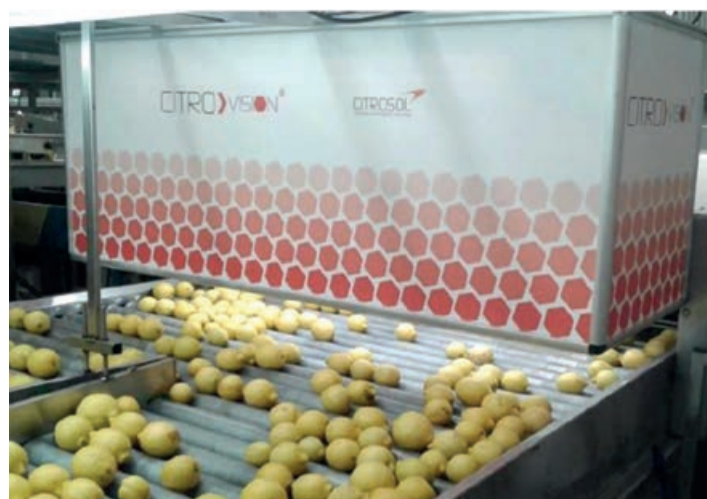
Sistema Citrovision® permite la dosificación del caudal de cera en función del flujo de fruta que en cada momento debe encerar el aplicador. / CITROSOL
