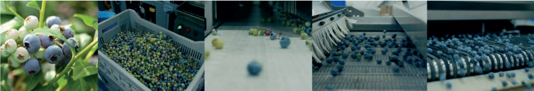
TOMRA Neon optimiza la eficiencia de la clasificadora óptica mediante la eliminación de más del 95% de los racimos de frutas y más del 90% de los arándanos rojos y verdes. / TOMRA FOOD
