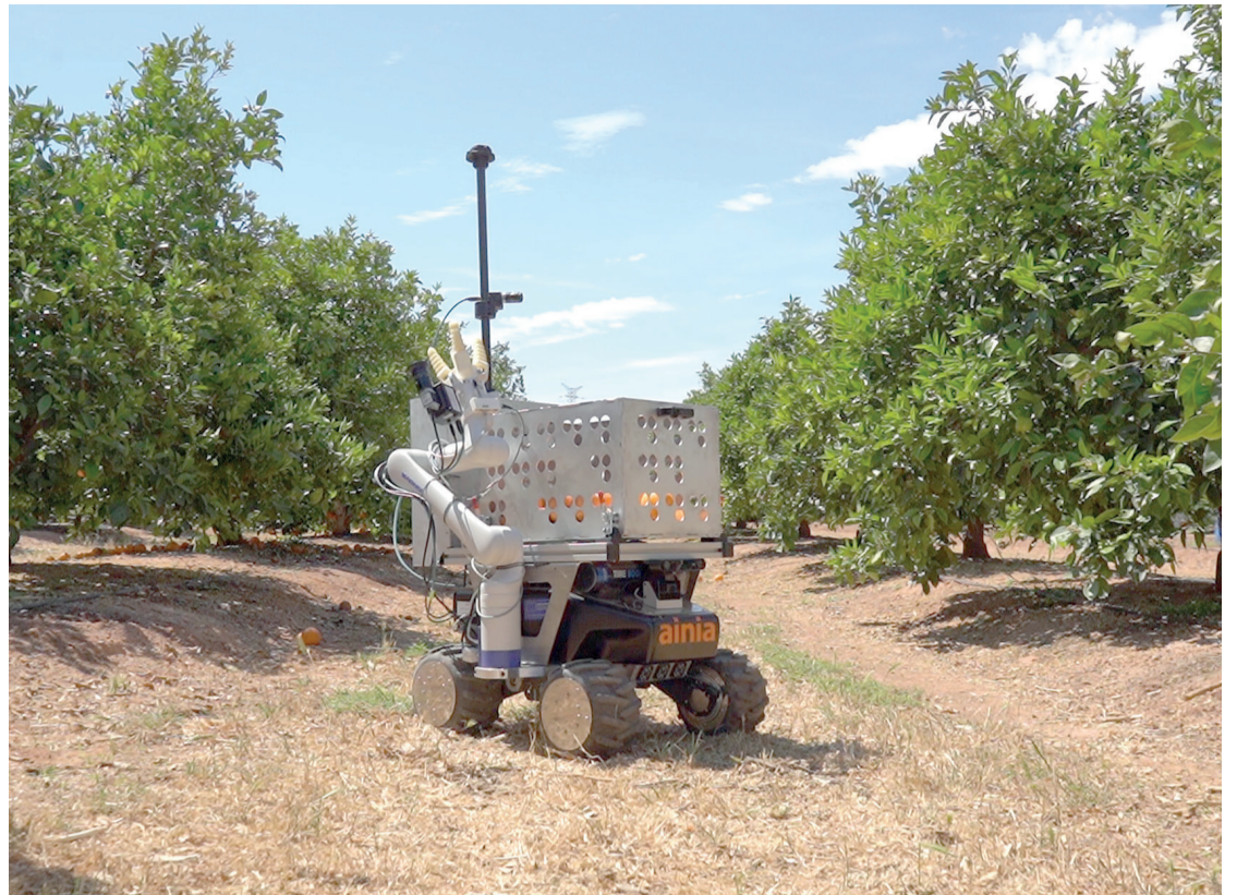
Ramonet, el equipo robótico autónomo para la recogida de fruta del suelo, desarrollado por el Ainia. / AINIA
