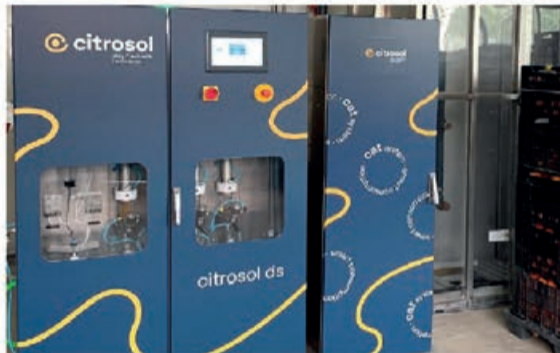
Figura 1. Imagen de un CATsystem® primer Sistema de Control Automático de los tratamientos fungicidas en postcosecha.
