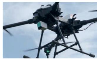
dispositivos reconocen incluso pequeños obstáculos, como cables finos o peligros repentinos, y mantienen un control dinámico de la altura. El sistema sin GPS se adapta a la altura de las copas de los árboles y optimiza la altura de pulverización. De esta forma, se reduce el uso de productos químicos, lo que beneficia tanto al medioambiente como a los productores.
