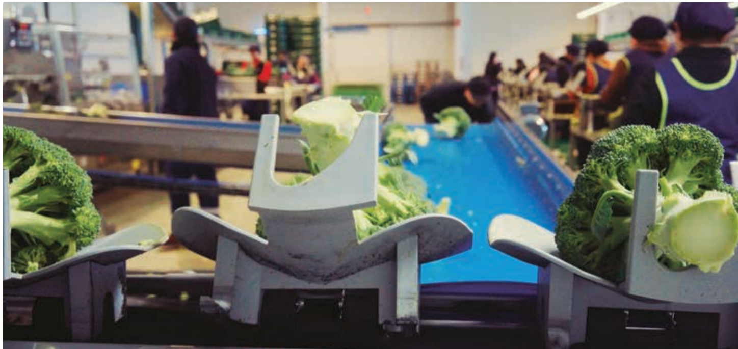
El CBP03 realiza dos tareas en una misma máquina: pesa el brócoli con alta precisión al tiempo que corta los rabos de manera eficiente. / VALSIC
