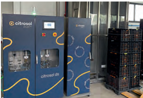
Figura 1. Dispositivo CATsystem®, primer Sistema de Control Automático de los tratamientos fungicidas en postcosecha.
