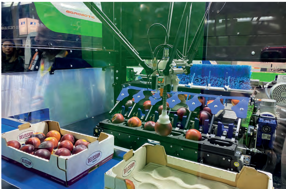
Muestra de cómo gracias a la robótica, la IA y la visión artificial Maf Roda consigue cear la fruta y colocarla en una caja con gran precisión y rapidez, alcanzando una de las tasas de producción más altas del mercado. / RAQUEL FUERTES
